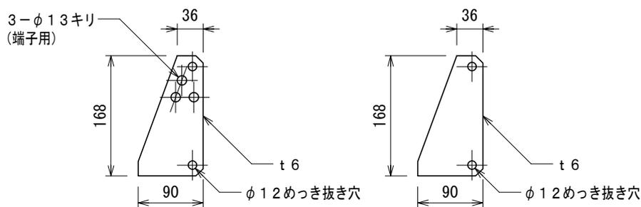
架台リブ詳細図 (端子取付部)
