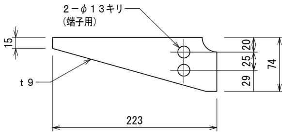
架台リブ詳細図 (端子取付部) S=1:4
