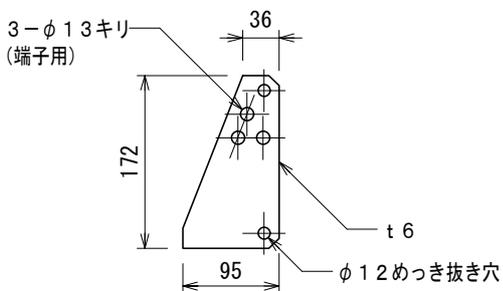
架台リブ詳細図 (端子取付部)
