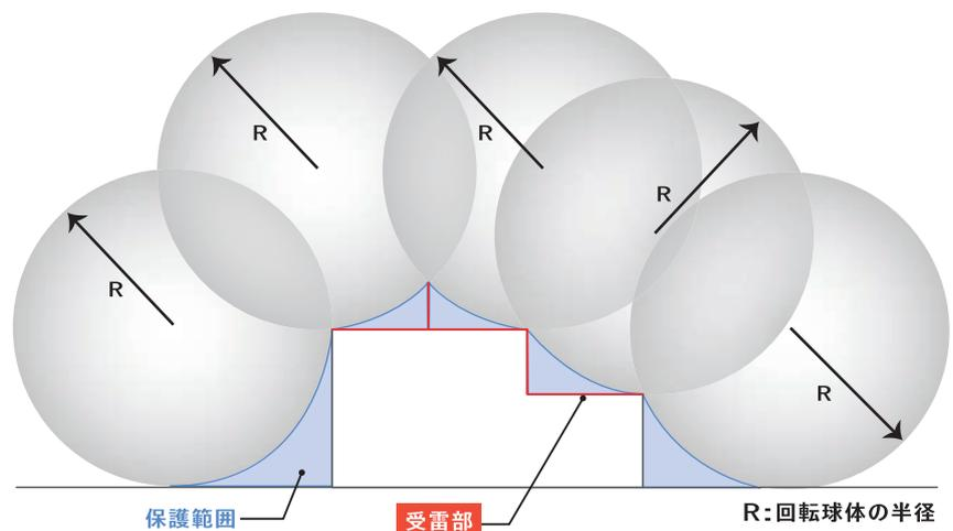
注記:受雷部導体は、選択した保護レベルに適合する半径を有する回転球体と、接触しているすべての点及び円弧上に配置する
